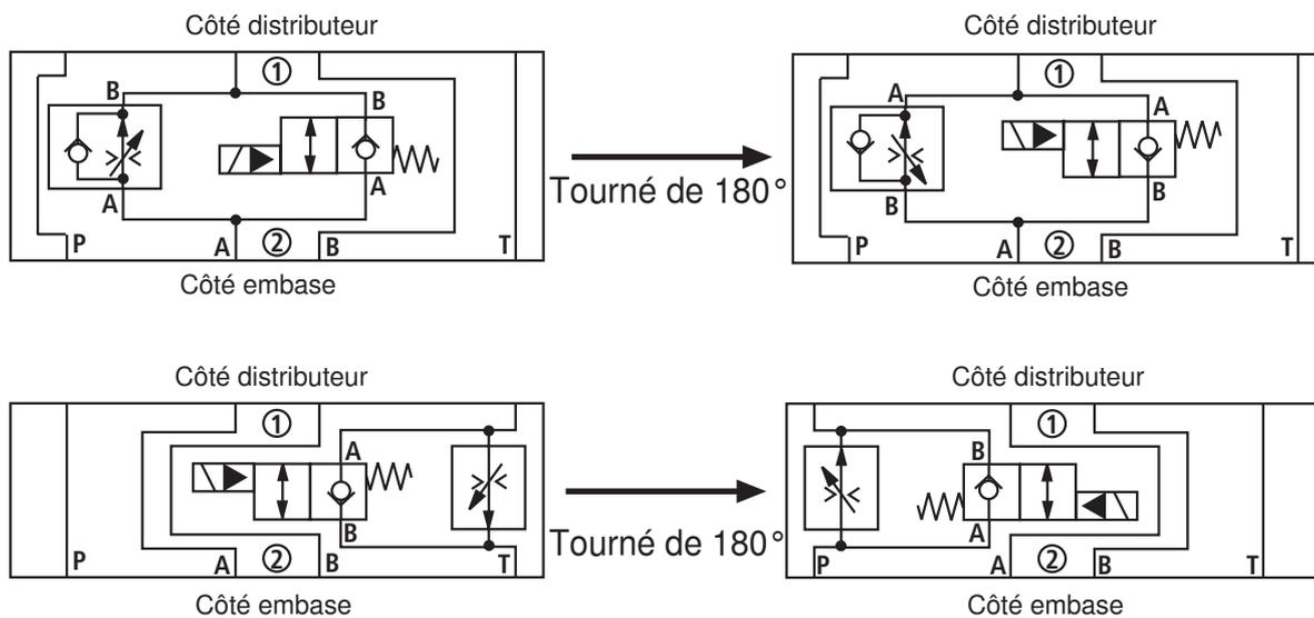
**Embases intercalaires sans raccord** (① = côté appareil, ② = côté embase)
